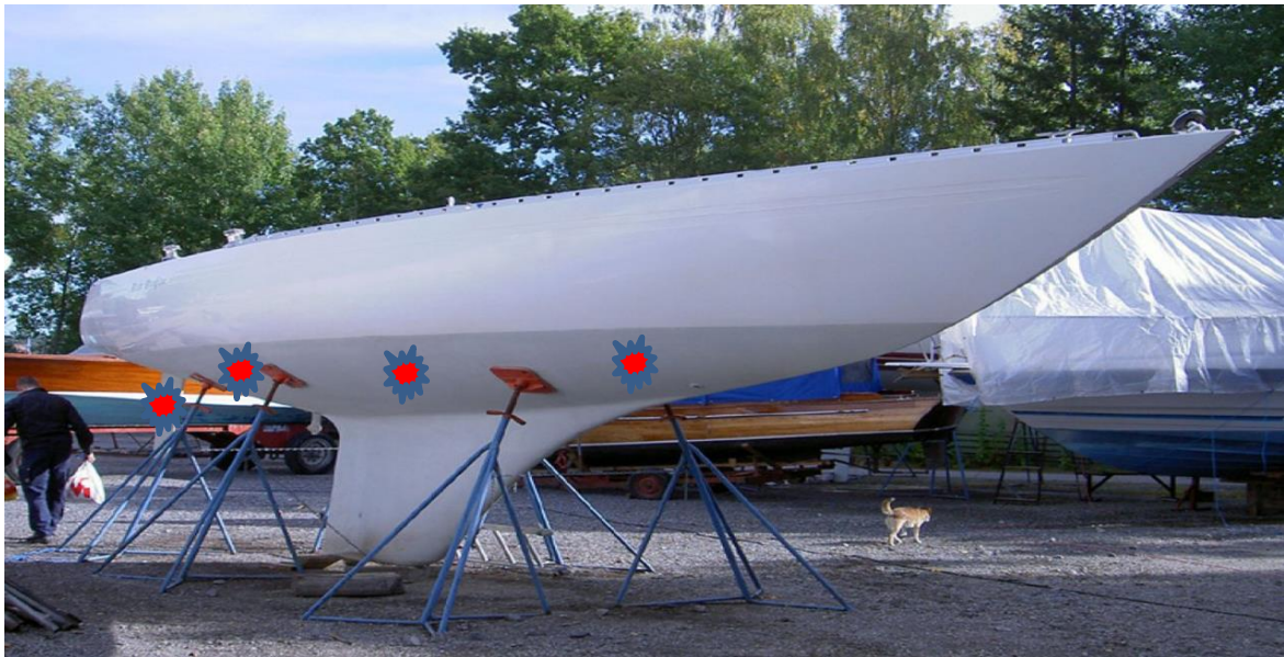
Figur 1. Mätpunkter på båtar mätta av Happy Boat AB. Mätningar utfördes 10-20 cm nedanför vattenlinjen på både styrbord och babord sida enligt bilden (styrbord bak, styrbord mitt, styrbord för, babord för, babord mitt och babord bak plus ömse sidor av rodrät). Om det var motorbåtar mättes på aktern istället för roder.
