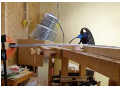
...för att mallningen ska bli rätt bör man därför böja dessa rutor något innan man ritar av från ramen. Ett par tvingar som man klämmer ihop ramen mot rutan med underlättar avsevärt.
