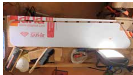
Här är rutan utsågad med sticksåg. Den bearbetas sedan med fil, eller rasp om man sågat slarvigt och behöver få bort mycket material. Därefter får man slutfinish med sandpapper.
