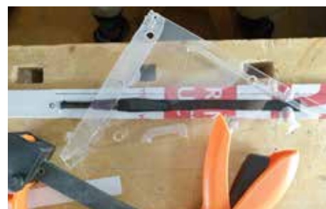
Innan jag började fräsa testade jag olika bredd, djup och position. Samt testade butylbandet. Genom att pressa en klar skiva ovanpå ser man tydligt om butylen flyter ut och tätar, och man får en bra känsla för hur mycket butyl man ska lägga på så det inte blir för tjockt. Detta moment tog mest tid i anspråk att testa sig fram till.
