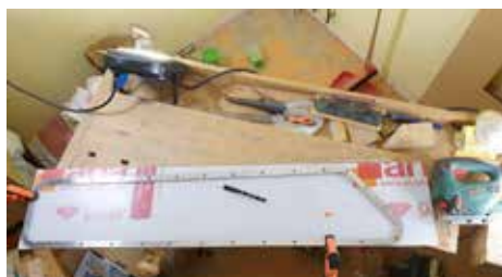
Använd ramen som mall för att rita ut kontur och hål. Behåll skyddsplasten på så länge det går, den skyddar bra mot repor.
